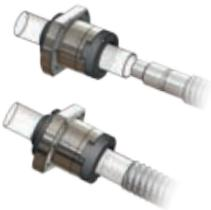
Je nach Gegebenheit wird nun der Dorn (mit Mutter) entweder über den Spindelzapfen geführt oder am Spindelende angesetzt. Achtung: Es ist darauf zu achten, dass er bündig am Gewindeanfang anliegt.
