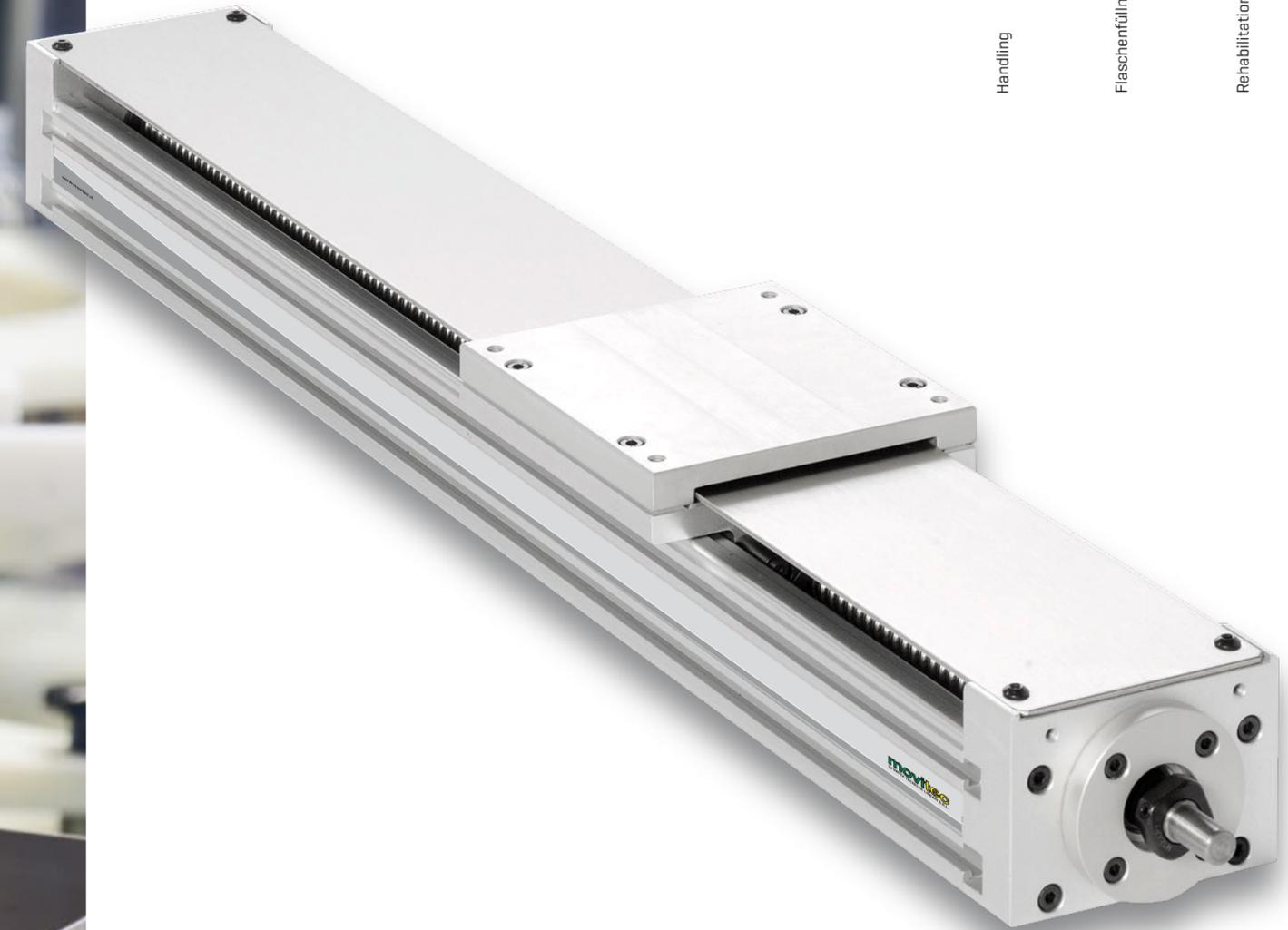
Die Lineareinheiten mit Kugelumlaufschlitten CV-CH-HV-HH-CC, mit Spindel oder Riemenantrieb, werden aus stranggepressten, eloxierten Aluminiumprofilen gefertigt. Das Gleiten eines oder mehrerer Kugelumlaufschlitten erfolgt auf zwei Führungen aus gehärtetem Stahl [58-62 HRC]. Die hohe Geschwindigkeit wird durch sehr große Kugeln mit 4-Punkt-Kontakt unter einem Druckwinkel von 45° gewährleistet. Sie sind ideal für Handling-Anwendungen.
