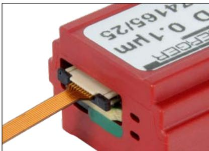
Korrekt eingeführter Sensorprint
