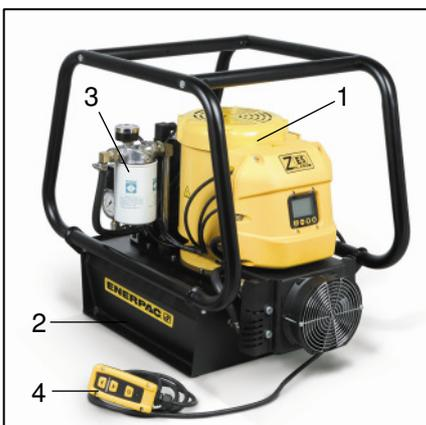
Für die Druckversorgung des Montagewerkzeuges kann ein handelsübliches Hydraulikaggregat verwendet werden. Dieses besteht in der Regel aus Elektromotor mit Pumpe (1), Ölbehälter (2), Druckregleinheit mit Manometer (3) und Handbedienpult (4).
