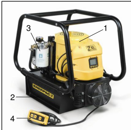
Für die Druckversorgung des Montagewerkzeuges kann ein handelsübliches Hydraulikaggregat verwendet werden. Dieses besteht in der Regel aus Elektromotor mit Pumpe (1), Ölbehälter (2), Druckregelunit mit Manometer (3) und Handbedienpult (4).
