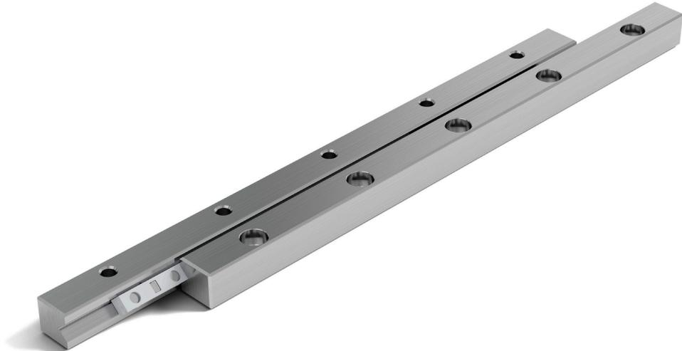
Die Linearführung vom Typ RN ist die konsequente Optimierung der R-Führung. Sie verfügt über identische Einbaumaße, ist aber aufgrund der erweiterten Kontaktflächen der Führungslaufbahnen leistungsfähiger. Die reduzierte Spaltbreite zwischen den Führungsschienen schützt zudem besser vor Verschmutzung.
