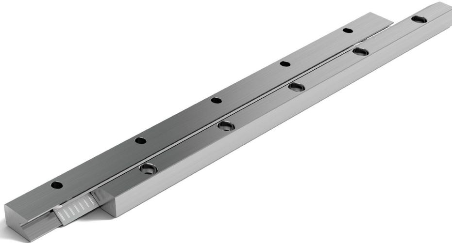
Die Linearführung vom Typ M/V ist dem Typ N/O ähnlich, unterscheidet sich jedoch in den äußeren Abmessungen. Bestückt mit Nadelkäfigen eignet sie sich besonders für Anwendungen mit hoher Belastung. Durch die Verwendung des Verbundkäfigs von SCHNEEBERGER ergeben sich im Vergleich zu ähnlichen Nadelführungen kleinere Verschiebewiderstände.
