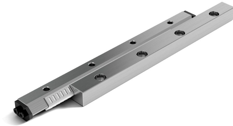
Die Linearführungen Typ N/O sind mit Nadelkäfigen bestückt und eignen sich besonders für Anwendungen mit hohen Belastungen. Durch die Verwendung des SCHNEEBERGER Verbundkäfigs aus Stahl und Kunststoff ergeben sich im Vergleich zu ähnlichen Nadelführungen kleinere Verschiebewiderstände.
