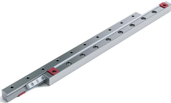
In jeder Linearführung kann sich der Käfig in der Längsachse aus dem Zentrum verschieben. Dieses sogenannte «Käfigwandern» kann die Effektivität Ihrer Anwendung maßgeblich beeinträchtigen. Einerseits ist durch den verschobenen Käfig die optimale Lastverteilung nicht mehr gegeben und andererseits muss der Käfig mit großem Kraftaufwand zentriert werden (Korrekturhübe).
