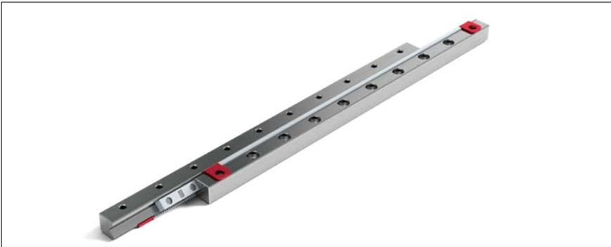
In jeder Linearführung kann sich der Käfig in der Längsachse aus dem Zentrum verschieben. Dieses sogenannte «Käfigwandern» kann die Effektivität Ihrer Anwendung massgeblich beeinträchtigen. Einerseits ist durch den verschobenen Käfig die optimale Lastverteilung nicht mehr gegeben und andererseits muss der Käfig mit grossem Kraftaufwand zentriert werden (Korrekturhübe).
