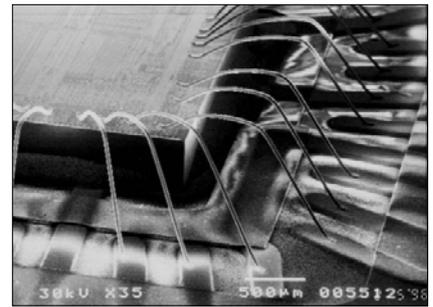
Aluminiumdrähte mit einem Durchmesser von 25 µm verbinden die Elektroden eines Mikrochips mit den Leiterbahnen eines Trägersubstrates.
