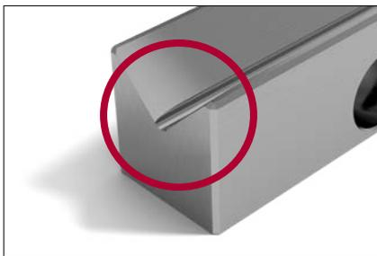
Damit der Käfigeinlauf möglichst wenig Pulsation verursacht, sind die kurzen Schienen mit gerundeten Einläufen zu versehen. Das Schleifen der Einläufe erfolgt nach Fertigstellung der Führungslaufbahn.
