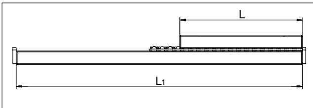
Überlaufende Käfige sind zweckmässig, wenn ein kurzer Tisch auf einer langen Führungsbahn bewegt werden soll. In jedem Fall muss die kurze Schiene der Führung einen gerundeten Einlauf aufweisen (Sonderausführung EG, siehe Kapitel 7.3), damit der überlaufende Käfig möglichst wenig Pulsation verursacht.
