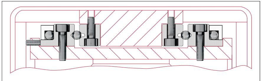
Beispiel mit Umlaufkörper von Typ NRT und Flachführungen von Typ E
