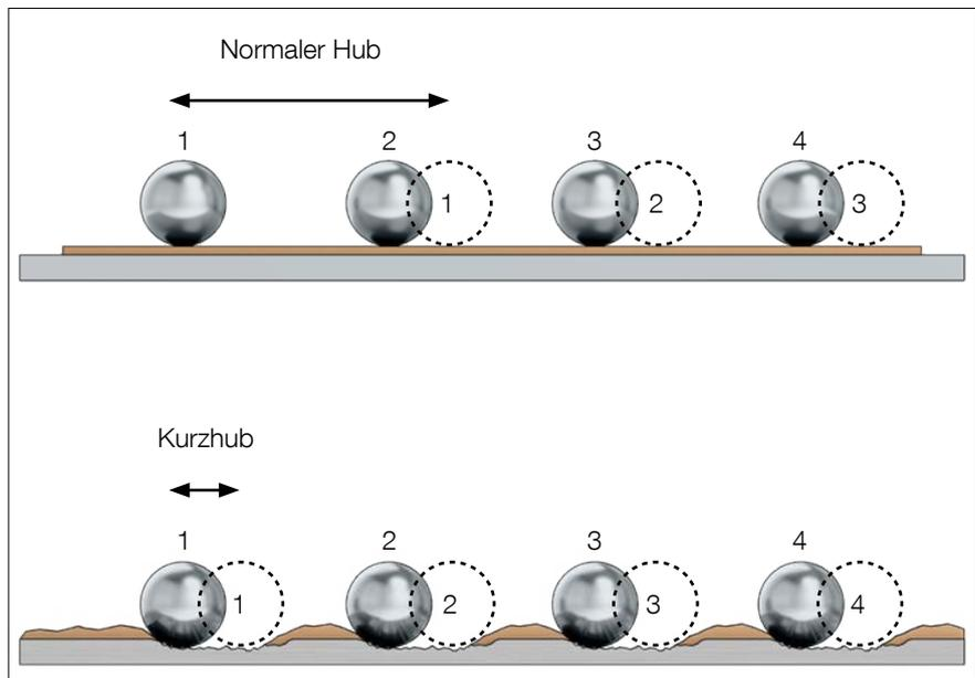
Weil die Laufbahnen punktuell verdichtet werden (sich Verschleissmulden bilden), verringert sich die Genauigkeit und Lebensdauer der Führung. Sind die Hübe zudem hochfrequent, kann ein gewöhnlicher Schmierstoff die Kontaktpunkte nicht mehr erreichen.
