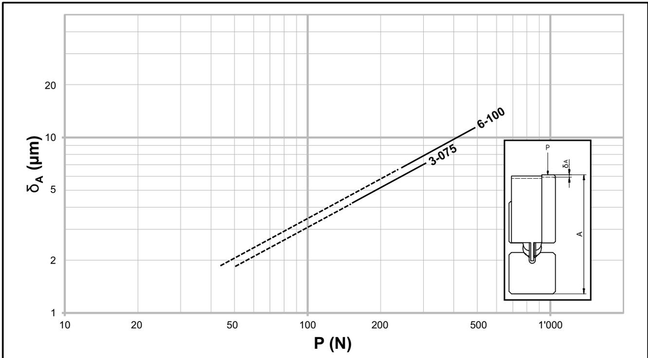
Die elastische Verformung der Umlaufkörper Typ SR in Verbindung mit Linearführungen Typ R oder RD.
