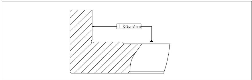
Die Winkelfehler der Auflage- und Anschlagfläche sollen  $0.3 \mu\text{m}/\text{mm}$  nicht überschreiten.
