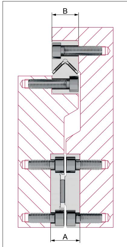
Beispiel mit Umlaufkörper von Typ NRT und Flachführungen von Typ E. Die vertikale Last wird durch höhenabgestimmte NRT getragen
