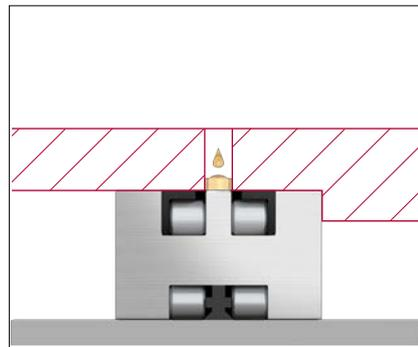
Ölführung durch die Schmieröffnung auf der Oberseite durch den Vorspannkeil NRV
