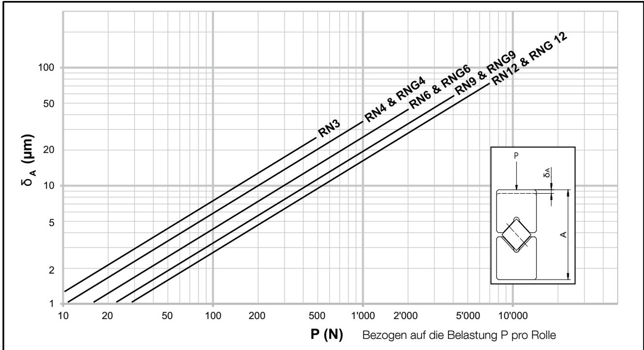
Die elastische Verformung der Linearführungen vom Typ N/O und M/V beim Einsatz nachfolgender Käfigtypen.
