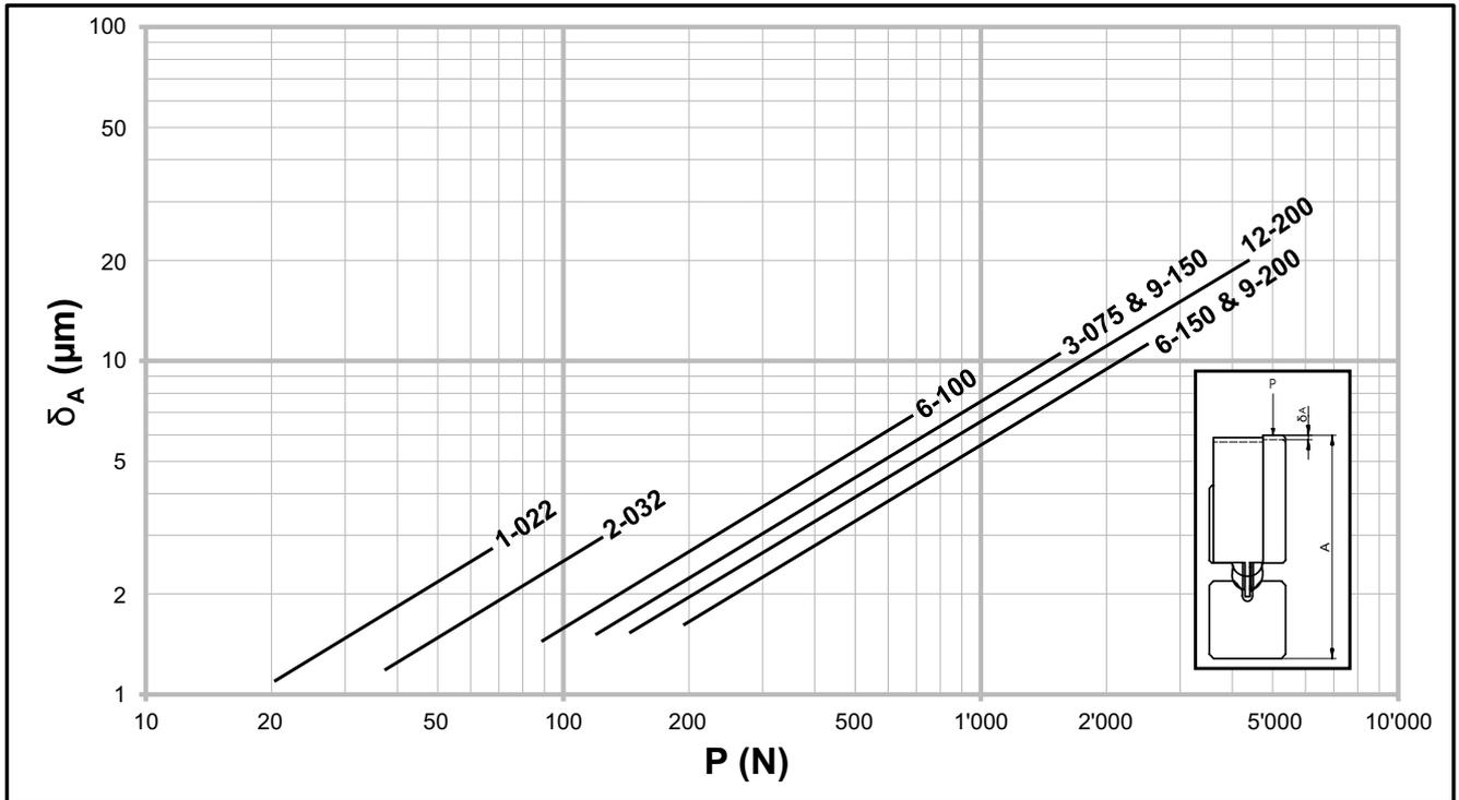
Die elastische Verformung der Umlaufkörper Typ SKD in Verbindung mit Linearführungen Typ R oder RD.
