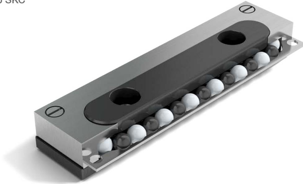
Der Umlaufkörper Typ SKC wurde für Minimalschmierung, Anwendungen in Vakuum und Reinraum entwickelt. Er ist aus DURALLOY® beschichtetem Stahl gefertigt und verfügt über Keramikugeln, welche durch Kugeln aus TEFLON® voneinander getrennt sind.
